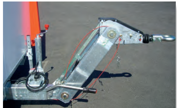
Achse und höhenverstellbare Zugdeichsel OPTIMA VB2 (AL-KO)
